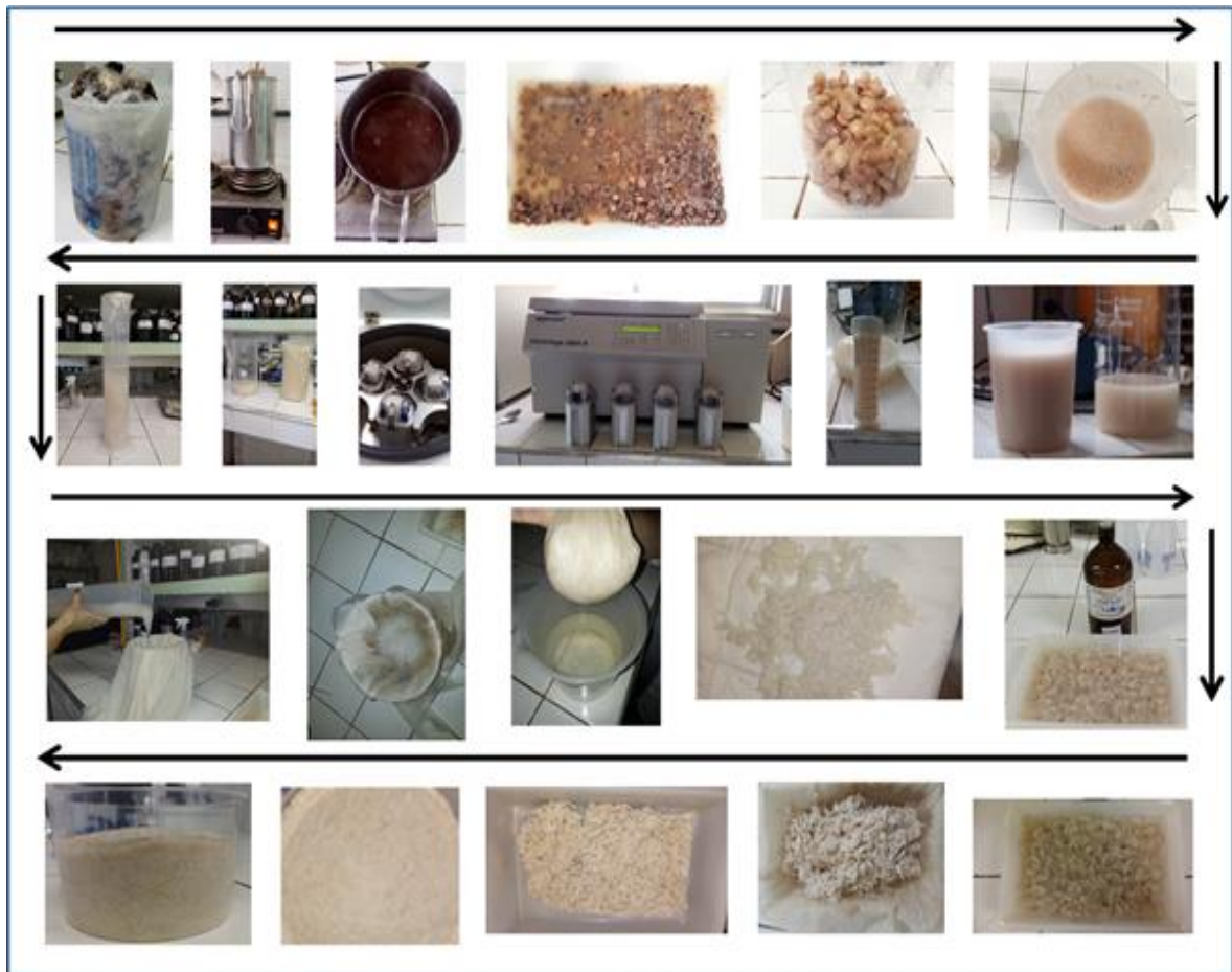
Figura 2 – Ilustração das etapas de obtenção de xiloglucana de sementes de Tamarindus indica .
