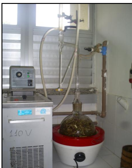
Figura 5: Processo de extração de óleo essencial de C. citratus em aparelho tipo Clevenger.
