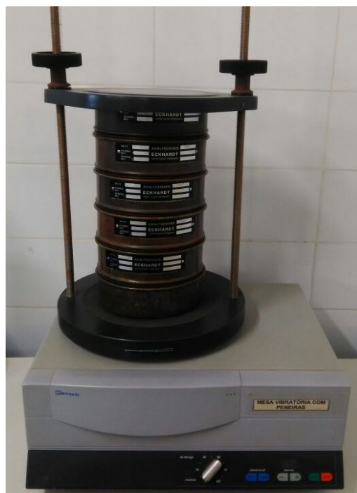
Figura 1 – Mesa vibratória para identificação da granulometria da farinha do albedo
