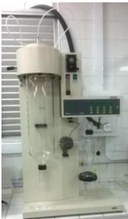
Figura 5 – Mini Spray Dryer Büchi B-290 utilizado na obtenção das microcápsulas.
