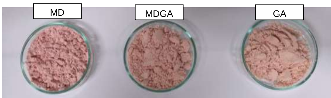
Figura 7 - Microcápsulas de resíduo de acerola obtidas por secagem em spray dryer .
