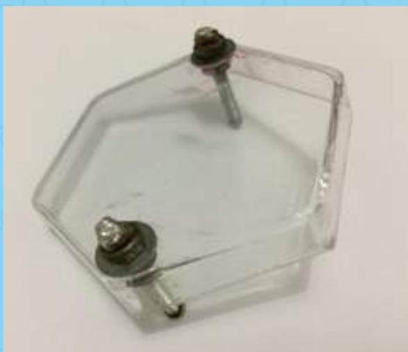
Figura 45- Conexão dos parafusos na tampa 4x4.
