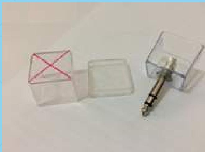
Figura 34- Caixa 3x3 com a marcação do furo (esq.) e plug acoplado(dir).
