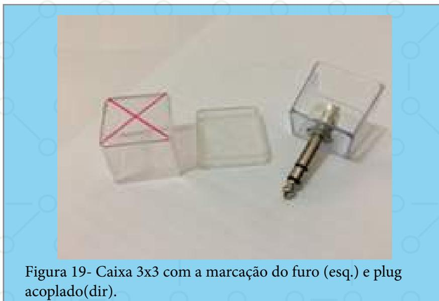
Figura 19- Caixa 3x3 com a marcação do furo (esq.) e plug acoplado(dir).
