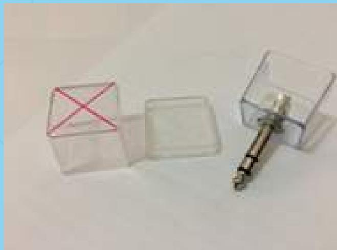
Figura 63- Caixa 3x3 com a marcação do furo (esq.) e plug acoplado(dir).
