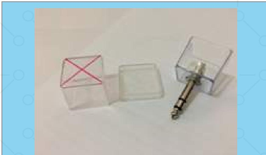
Figura 15- Caixa 3x3 com a marcação do furo (esq.) e plug acoplado(dir).
