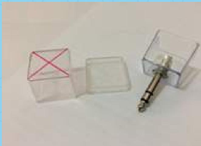
Figura 50- Caixa 4x4 com a marcação do furo (esq.) e plug acoplado (dir.).
