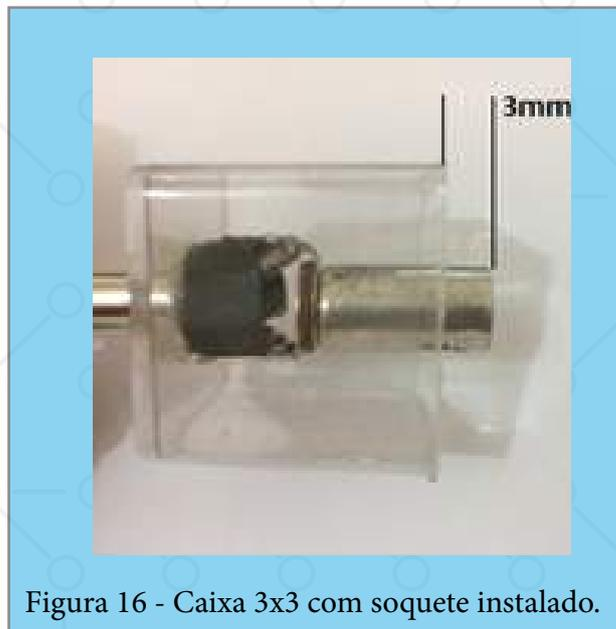
Figura 16 - Caixa 3x3 com soquete instalado.
