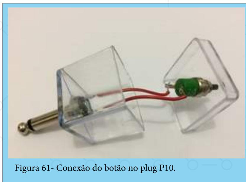
Figura 61- Conexão do botão no plug P10.
