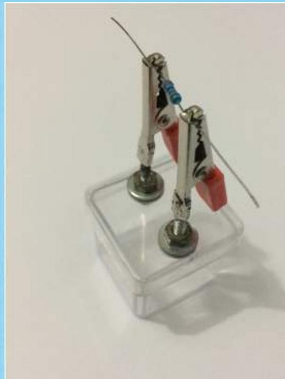
Figura 41- Módulo garra jacaré com um resistor acoplado.
