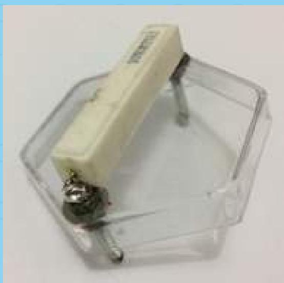
Figura 46- Conexão do resistor na tampa 4x4.
