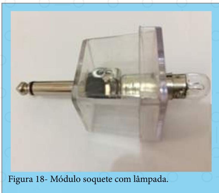
Figura 18- Módulo soquete com lâmpada.
