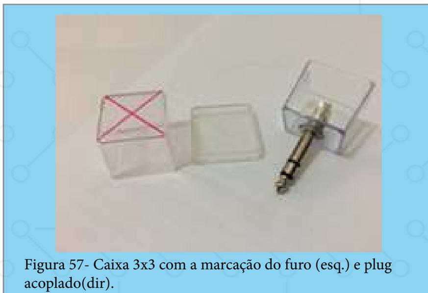
Figura 57- Caixa 3x3 com a marcação do furo (esq.) e plug acoplado(dir).
