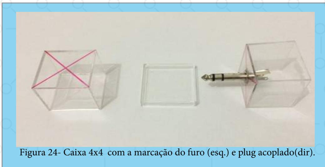
Figura 24- Caixa 4x4 com a marcação do furo (esq.) e plug acoplado(dir).
