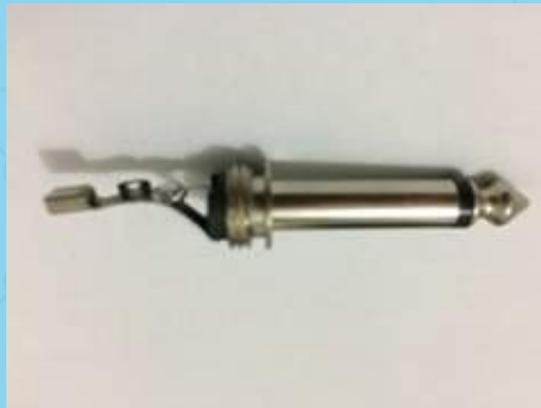
Figura 77- Plug P10 com as extremidades soldadas.
