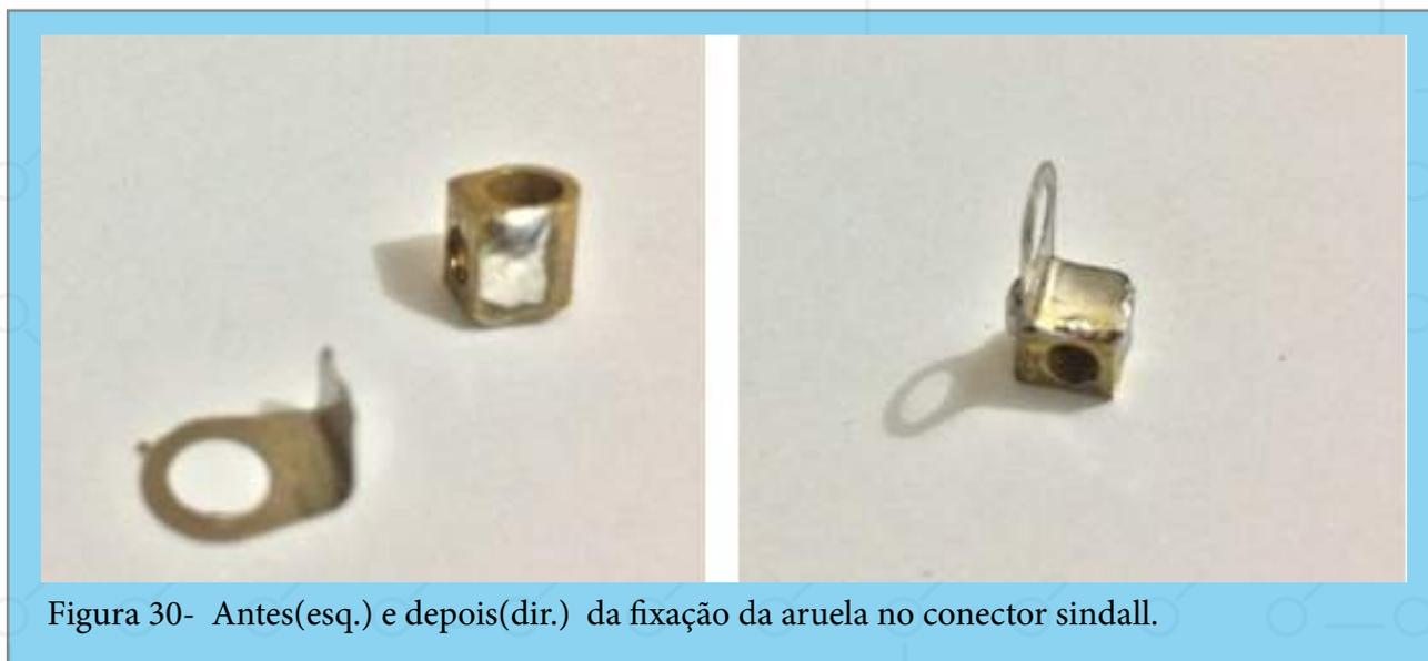
Figura 30- Antes(esq.) e depois(dir.) da fixação da aruela no conector sindall.
