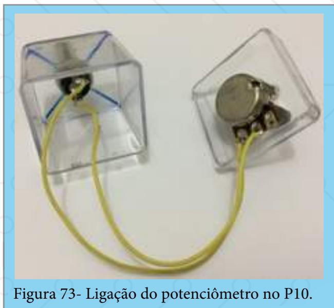
Figura 73- Ligação do potenciômetro no P10.
