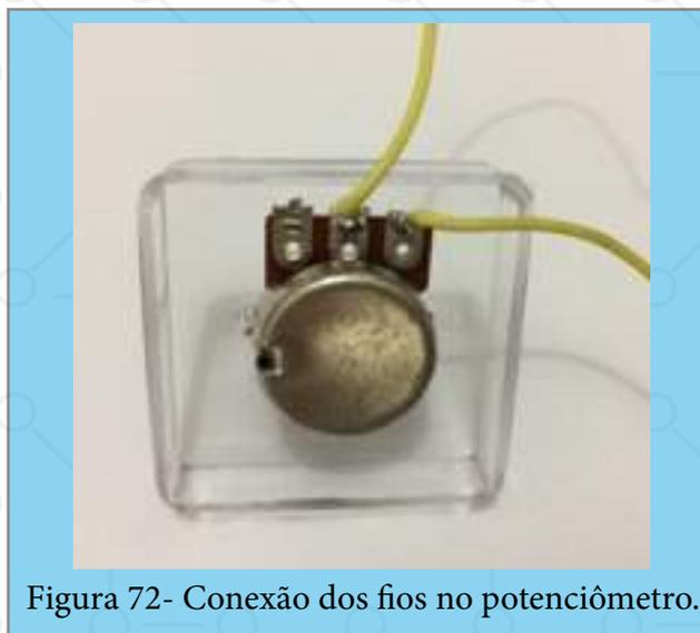
Figura 72- Conexão dos fios no potenciômetro.
