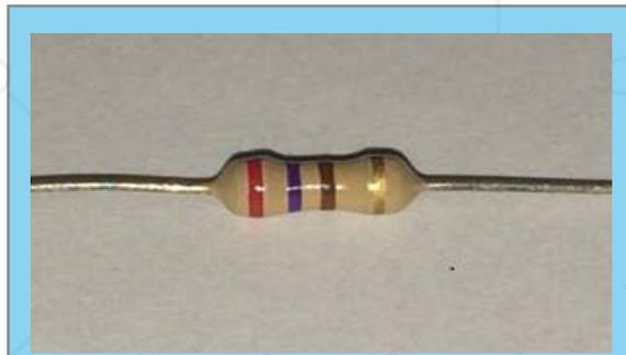
Figura 2 - Resistor (resistência) comercial.
