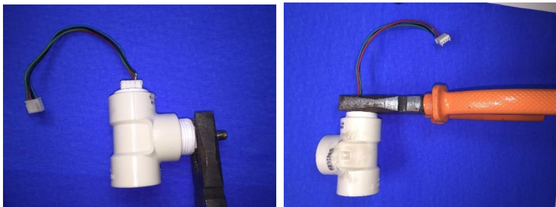
Figura 11: Taps com a válvula e o sensor encaixados no cano. Fonte: próprio autor
