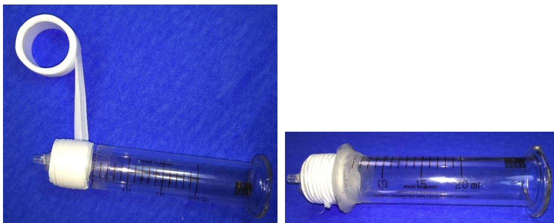
Figura 12: Seringa com a fita veda rosca. Fonte: próprio autor.
