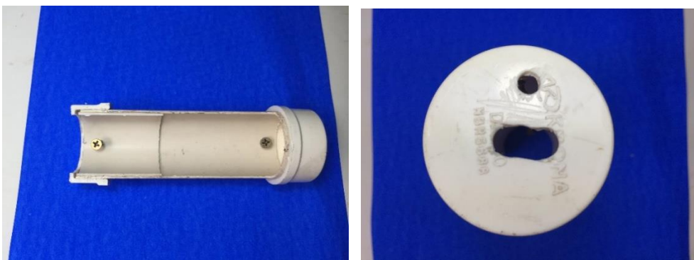
Figura 16. A esquerda – vista da montagem do apoio. A direita – Corte feito para atravessar os fios do sensor. Fonte: Próprio autor
