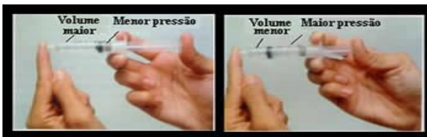
Figura 31: Utilização de uma seringa para verificar o aumento ou redução da pressão. Fonte: http://brasilescola.uol.com.br/quimica/transformacao-isotermica-ou-lei-boyle.htm .
