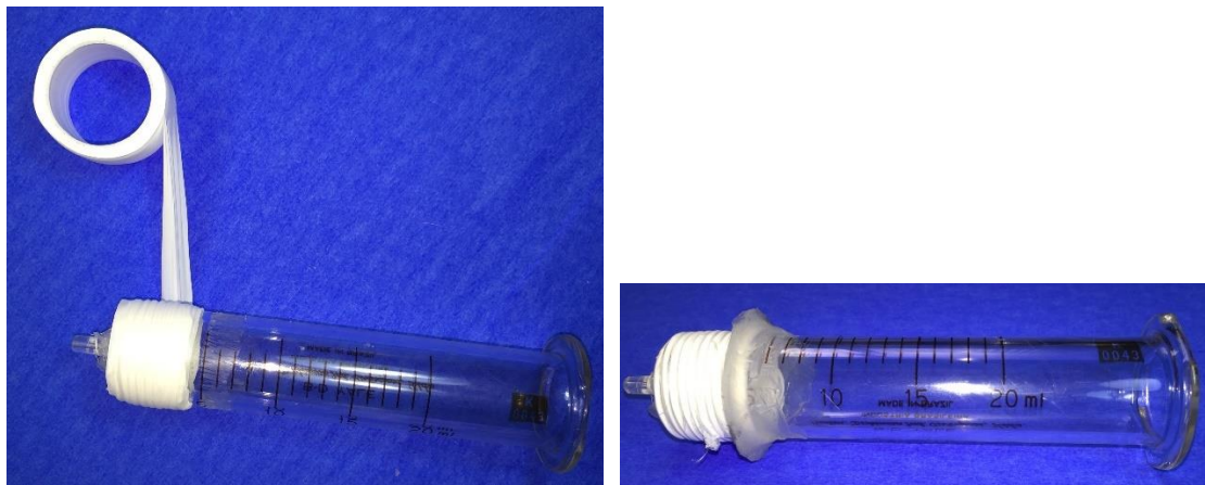
Figura 6: Seringa com a fita veda rosca. Fonte: próprio autor.
