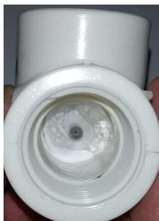
Figura 8: Vista de frente da fixação da seringa. Fonte próprio autor.
