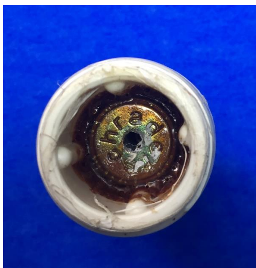
Figura 10: Vista interna do taps com a válvula encaixada. Fonte: próprio autor
