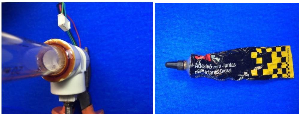
Figura 9. A esquerda – vista da montagem da seringa no cano pvc tê. A direita – Cola utilizada para vedação do sistema. Fonte: Próprio autor
