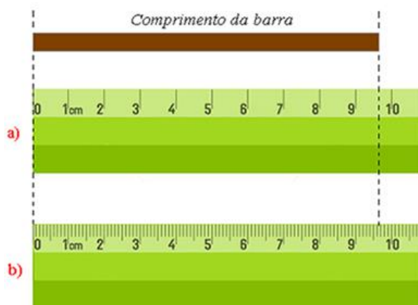
Figura 28: Medição do comprimento da barra. Fonte:
