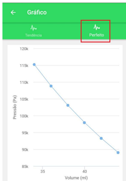
Figura 42: Gráfico produzido da equação (1). Fonte: próprio autor
