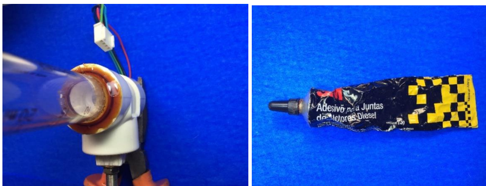
Figura 15. A esquerda – vista da montagem da seringa no cano pvc tê. A direita – Cola utilizada para vedação do sistema. Fonte: Próprio autor
