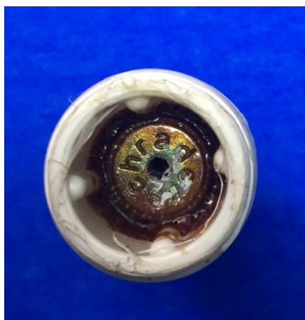
Figura 4: Vista interna do taps com a válvula encaixada. Fonte: próprio autor
