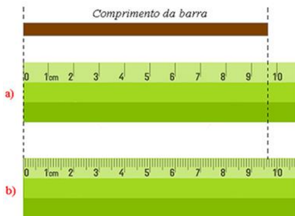
Figura 32: Medição do comprimento da barra. Fonte:
