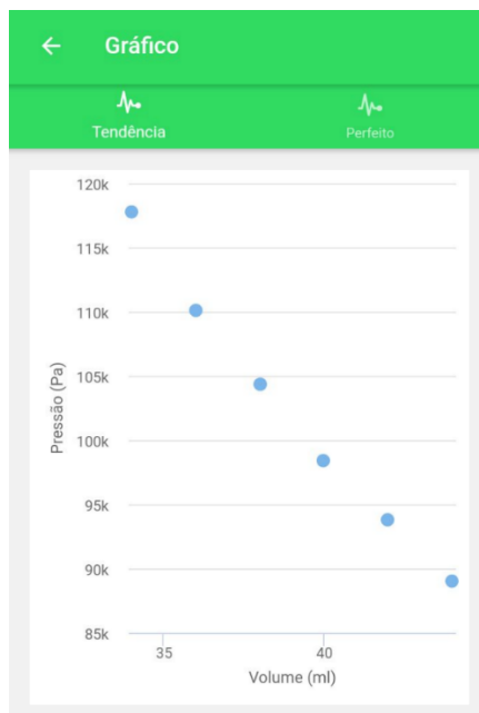
Figura 37: Gráfico produzido a partir dos dados de pressão e volume. Fonte: Próprio autor
