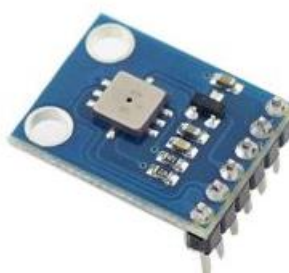
Figura 13: Representação do sensor BMP 085. Fonte: https://www.zonamaker.com.br/wp-content/uploads/2017/08/bmp085-300x271.jpg
