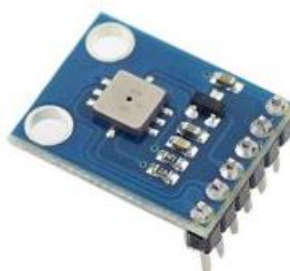
Figura 18: Representação do sensor BMP 085. Fonte: https://www.zonamaker.com.br/wp-content/uploads/2017/08/bmp085-300x271.jpg
