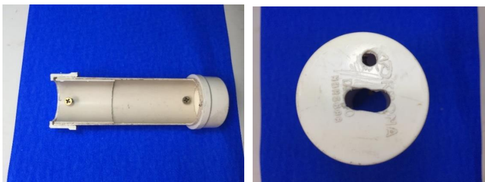
Figura 11. A esquerda – vista da montagem do apoio. A direita – Corte feito para atravessar os fios do sensor. Fonte: Próprio autor
