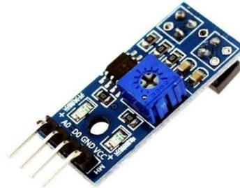
Figura 72 – Potenciômetro do sensor de refletância
