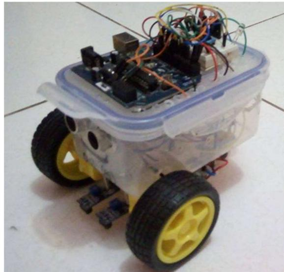
Figura 71: robô seguidor de linha
