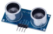
Figura 43: Sensor ultrassônico Fonte: Próprio autor
