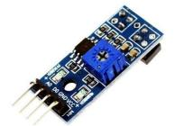
Figura 72 – Potenciômetro do sensor de refletância Fonte: https://www.dhresource.com/
