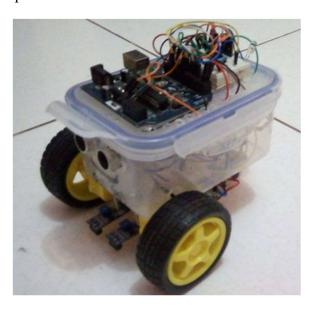
Figura 71: robô seguidor de linha Fonte: Próprio autor
