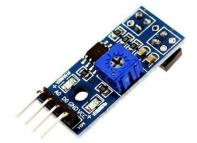
Figura 72 – Potenciômetro do sensor de refletância Fonte: https://www.dhresource.com/
