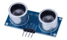
Figura 43: Sensor ultrassônico Fonte: Próprio autor
