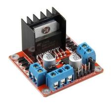
Figura 51- Módulo Ponte H para Arduino Fonte: http://s3.amazonaws.com
