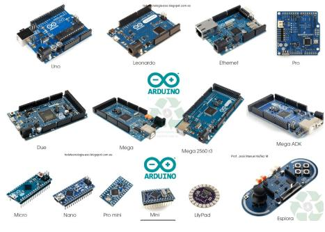
Figura 02 – Alguns tipos de Arduino
