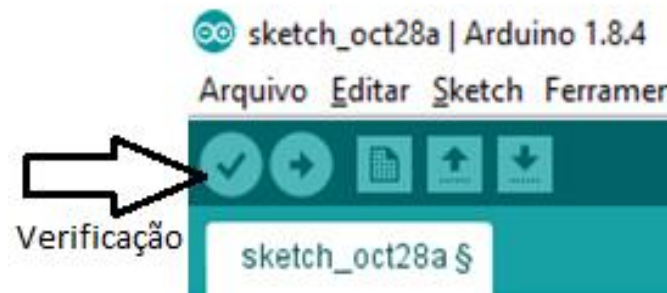
Figura 5 - Software IDE Arduino 1.8.4. Ao editar algum sketch verifique se não há algum erro, clicando no botão conforme indicação da imagem, ou use as teclas ctrl+R . A verificação consiste na compilação do sketch , convertendo em algo que faça sentido à placa.
