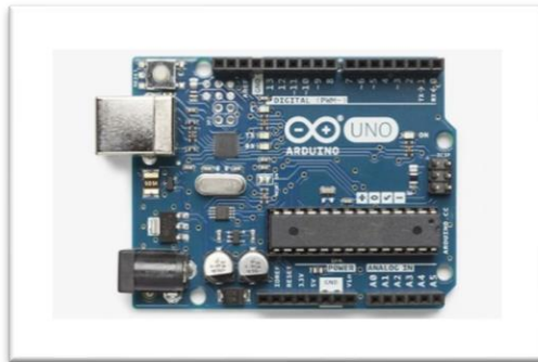
Figura 2- Imagem de um Arduino UNO. Na imagem, os pinos digitais estão localizados na região superior, os pinos analógicos na região inferior. Na região inferior esquerda, o bloco de pinos contém um pino de 5 volts e outro de 3,5 volts, além dos pinos destacados pela faixa branca, onde contem 2 pinos GND, correspondentes ao ground , ou seja, um aterramento.
