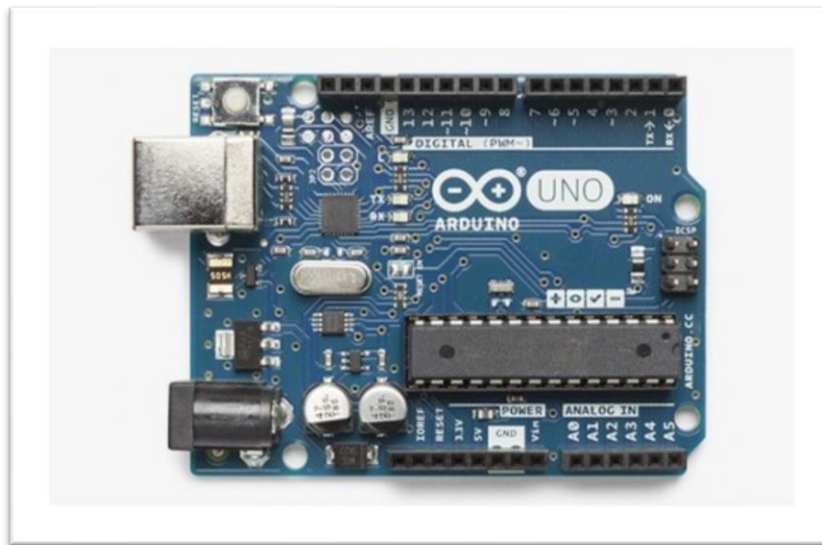
Figura 2 - Imagem de um Arduino UNO. Na imagem, os pinos digitais estão localizados na região superior, os pinos analógicos na região inferior. Na região inferior esquerda, o bloco de pinos contém um pino de 5 volts e outro de 3,5 volts.
