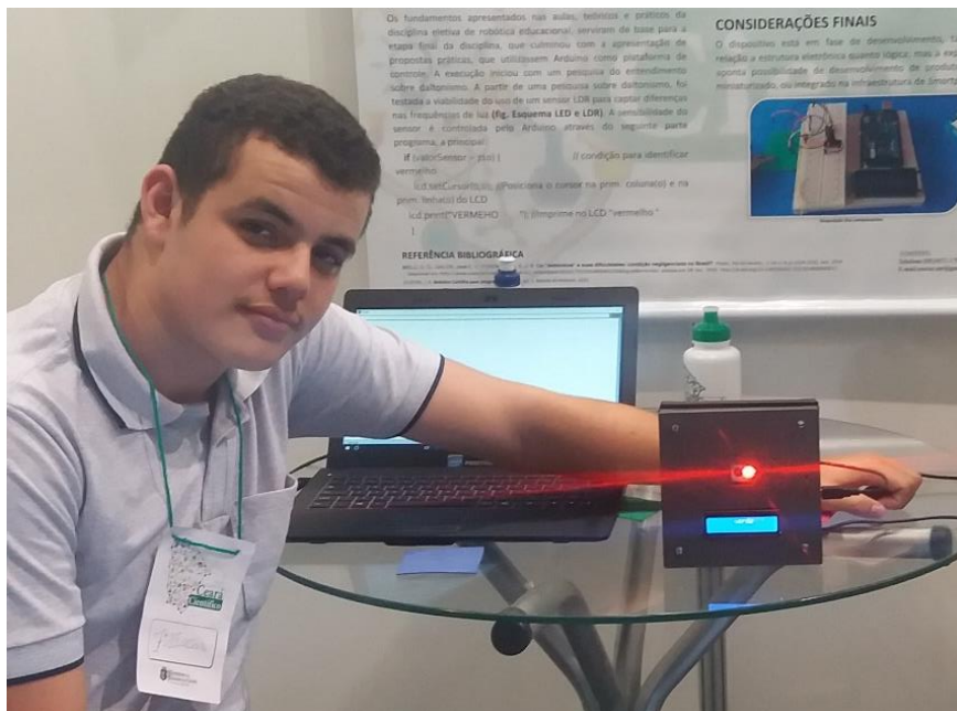
Figura 21 - Apresentação do trabalho no dia 16 de dezembro de 2016 no estande 05 - Robótica educacional do Ceará Científico. Em destaque o dispositivo e um dos alunos participante do projeto, Francisco Lucas de C. Damasceno. O dispositivo, exibia no LCD a cor do objeto posicionado sobre o sensor (LED emissor RGB e LDR).
