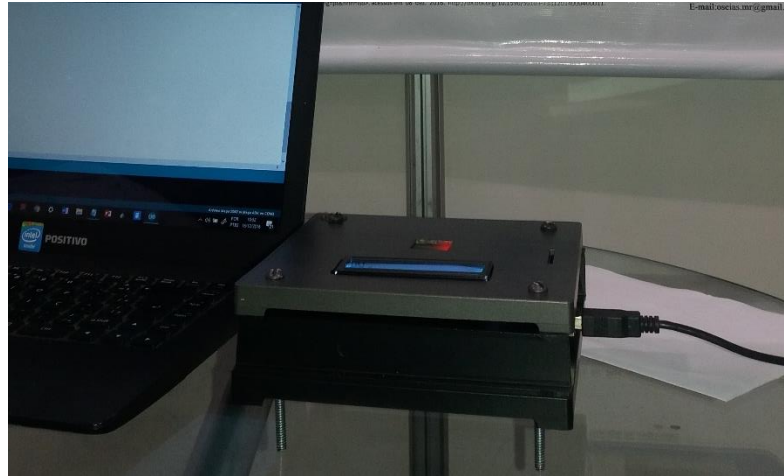
Figura 19 - Sensor RGB. Dispositivo desenvolvido a partir de atividades experimentais referentes ao Capítulo 12 do ebook . O nome RGB se deve ao fato de estar sendo utilizado um LED RGB que emite luz nas cores Vermelho, Verde e Azul. O dispositivo exibia numa tela LCD a cor do objeto posicionado sobre o sensor.
